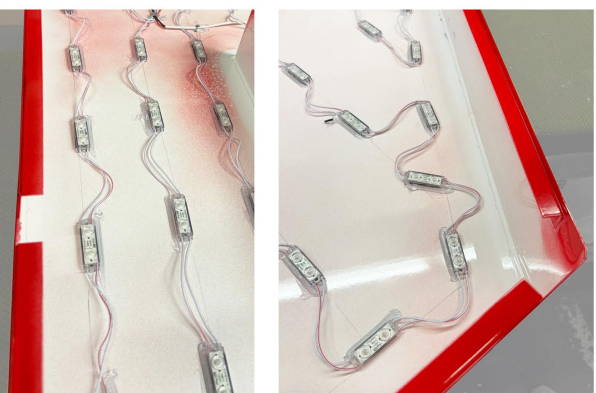
V1-LEDs im Leuchtkasten
